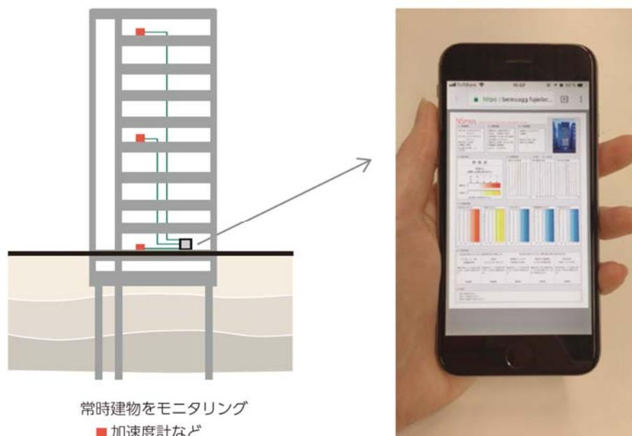
図 1. 加速度計配置例と結果表示例
